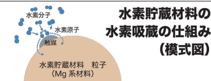
図 水素を「ためる」ための代表的な手法と、貯蔵材料による吸蔵メカニズムの概略
